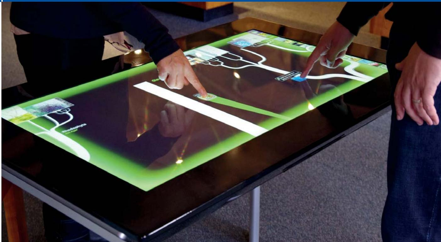
Технология P-CAP Touch (Projective Capacitive Touch) применяется для мониторов больших диагоналей (от 32" до 84").
