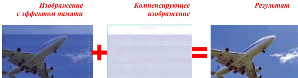
Применение технологии BIC свидетельствует, что плазменный дисплей может без последствий работать со статическим изображением и является лучшим решением для диспетчерских и ситуационных центров. Это также значит, что видеостена готова к эксплуатации 24 часа в сутки 7 дней в неделю, без технологического перерыва.
