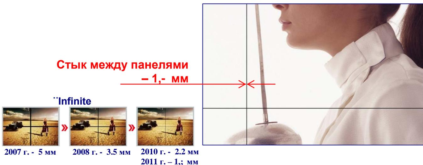
Стык между двумя панелями в новой модели OPM-4260 – 1,9 мм, что минимизирует искажения общей картинке и позволяет продемонстрировать широкое и чистое изображение зрителям.
