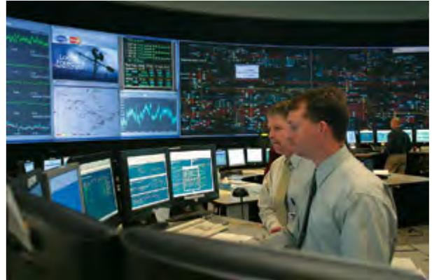
**Плазменные видеостены (стены на плазменных панелях, MPDP, Multi-PDP, Infinite, OrionPDP)** - стены, минимальным модулем для сборки которых является плазменная панель (**PDP – Plasma Display Panel**).
